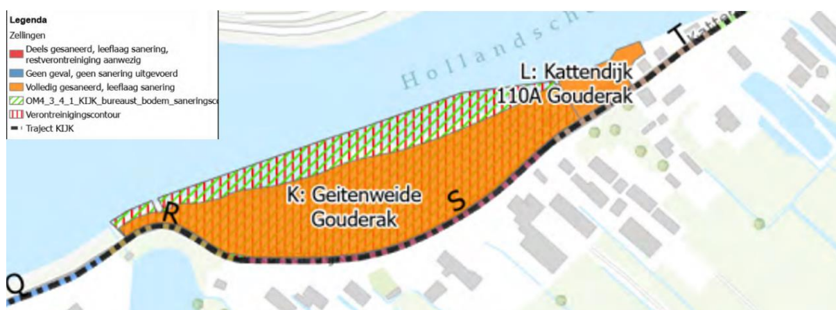
Figuur 2-5: Gesaneerde locatie dijkvakken R en S
