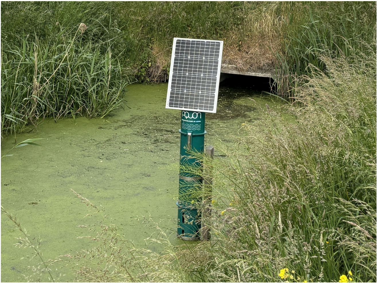
(a) Nitraatmeter met een zonnecel
